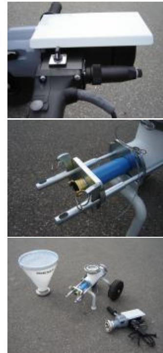
Vielseitig einsetzbare, sehr leistungsstarke Pumpe mit einfacher Handhabung. Leicht tragbar und mittels Keil- und Bajonettverschluss einfach zu zerlegen und zu reinigen. PU-Trichter gleitbeschichtet. Stufenlose, auch per Fernbedienung zu bedienende, Drehzahleinstellung. Geeignet für alle gängigen pastösen vorgemischten Materialien bis zu einer Körnung von 3 mm wie z.B.:
