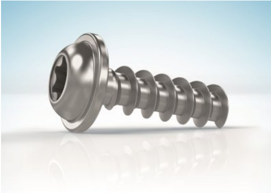
Bild2: Der optimierte Gewindekern der Remform-Schrauben erhöht die Schwingfestigkeit und das Bruchdrehmoment der Schraube, was zu einer stabileren Verbindung der Fügepartner führt.
