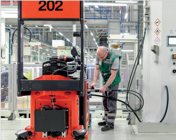
© BMW Group - Betankung eines wasserstoffbetriebenen Routenzuges mit der WEH® TK16 H<sub>2</sub> 35 MPa
