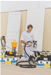
Besser, schneller, wirtschaftlicher: Der Einsatz der NAST-Technologie zum Lackieren von Bauteilen wie Türen, Heizkörpern etc. bringt gegenüber dem Beschichten mit Rolle und Pinsel eine Zeitersparnis von 60 bis 80 Prozent, besseres Deckvermögen und eine optimale Oberflächenqualität.
