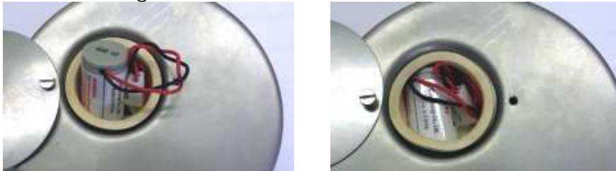
Zum Wechseln einfach eine Schraube hinten lösen und die andere etwas lockern, die Batterie am Kabel herausziehen. Etwas versetzt einlegen und wieder schließen
