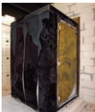
Das akkreditierte Prüfinstitut MPA Dresden prüft die Erfüllung von Brandschutzanforderungen durch Gefahrstoffschränke. So müssen Schränke bis 1.000 Liter Volumen beispielsweise eine Feuerwiderstandsfähigkeit von mindestens zwanzig Minuten aufweisen. Aufbau und Betrieb haben so zu
