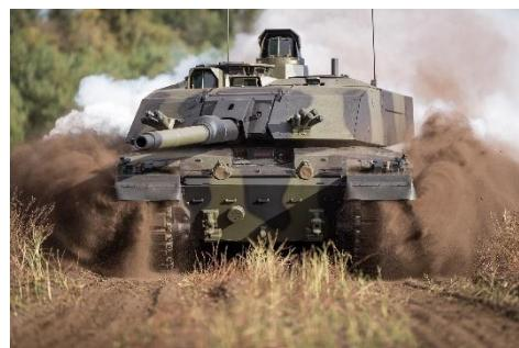
Wie im Mai 2021 angekündigt, wird RBSL insgesamt 148 Kampfpanzer des Typs Challenger 2 zur neuen Konfiguration Challenger 3 modernisieren. Hierzu gehören unter anderem ein neuer Turm mit digitaler Systemarchitektur und Rheinmetalls bewährter 120-mm-Glattrohrkanone L55A1 einschließlich modernster Wucht- und
