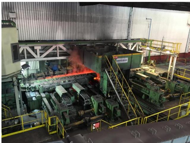
Das neue Duo-Reversier-Blockgerüst mit Verschiebe- und Kanteinrichtung für Třinecké železářny.
