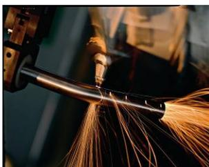
**Bild:** Laserschneiden von Rohren mit Rofins CO<sub>2</sub>-Slab-Laser (Quelle: BLM Group)
