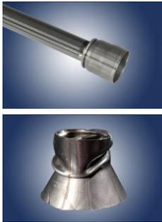
**Bild:** Eine sichere Verbindung: nach der Schweißung verformte Rohre halten selbst höchsten Beanspruchungen stand
