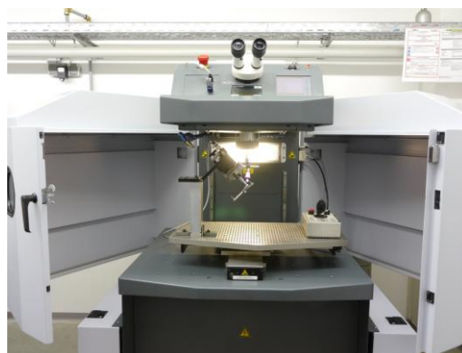
Abb. 3: Der Integral für joystick-geführtes Auftragschweißen oder CNC Bearbeitung
