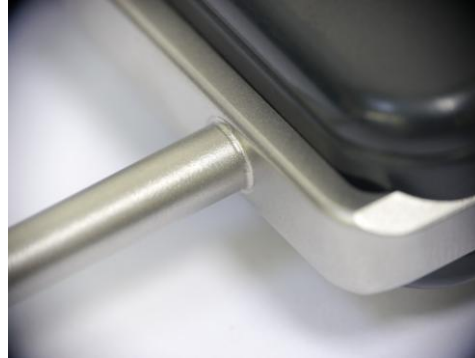
Abb. 7: Optisch feinste Verschweißungen im Sichtbereich
