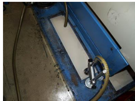
Bild Nr. 06-06 MK_KP-.jpg. Die Fremdölabscheidung mit dem TM450UV von MKR Metzger läuft im Bypass-Verfahren während des Maschinenbetriebs.
