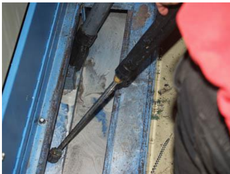
Bild Nr. 06-03 MK_KP-Hochdruck.jpg. Mit Hochdruckkanze aus dem SF-500 lassen sich die Behälter mühelos säubern.
