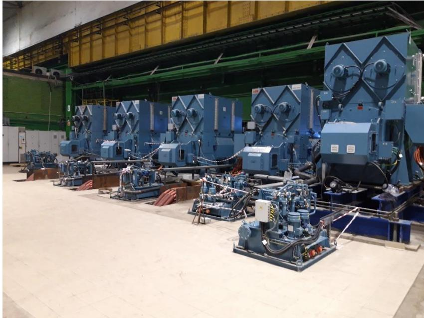
Die neuen Hauptantriebe der Walzgerüste: Bereits in Phase 1 wurde der Hauptantrieb für das erste Gerüst erneuert. In Phase 2 wurde der neue Antrieb für den Aufwickelhaspel installiert. Die Walzgerüste zwei, drei und vier erhielten in der Phase 3 neue Hauptantriebe.
