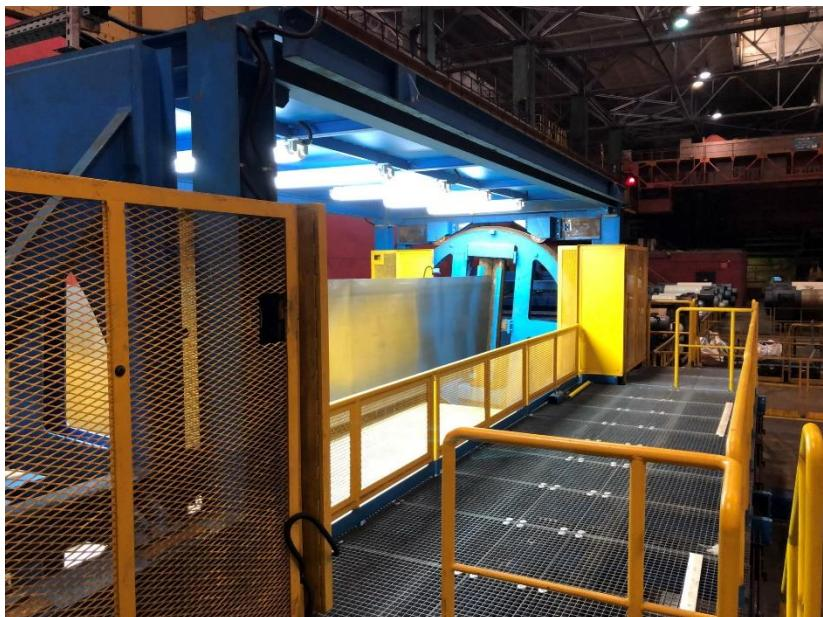
Die Offline-Bandinspektionsstation Rotary Inspect im Auslaufbereich der Tandemstraße bietet eine sichere, ergonomisch optimierte Inspektion von Bandober- und -unterseite.
