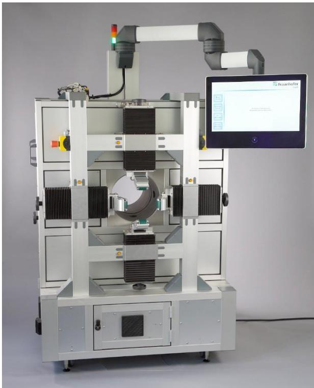
Terahertz-Messsystem mit vier parallelen Messköpfen zur Inline-Kontrolle von beschichteten Kunststoffrohren. ©Fraunhofer ITWM.
