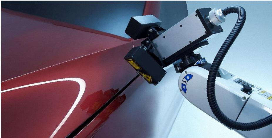
Roboter-geführter Terahertz-Messkopf inklusive Positionierungssensoren zur zuverlässigen Schichtdickenmessung. ©Fraunhofer ITWM
