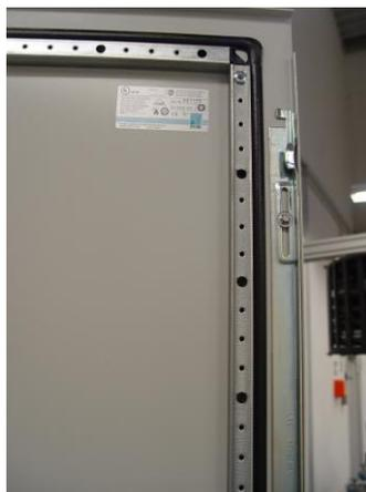
La bonne capacité de retrait du joint en mousse polyuréthane Fast Cure Fermapor® K31 est déterminante pour une étanchéité élevée constante à l'état fermée, en cas d'ouvertures et de fermetures fréquentes de la porte de l'armoire électrique.
