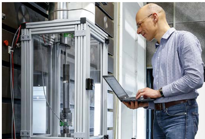
Hardware-in-the-Loop-Prüfung von aktiven Fahrwerkskomponenten. Foto: Fraunhofer LBF
