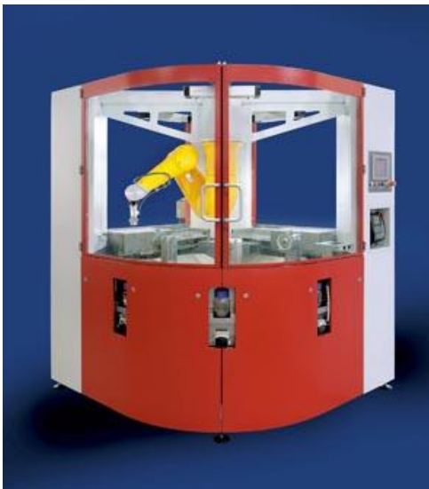
Bild Nr. 11-01 ZW_OE-PolierMasch.jpg Anspruchsvolle Herausforderung: Die Zeltwanger Automation GmbH und die Oechsler AG bringen Keramik für Design- und Sichtteile in Premiumfahrzeugen mit einem neuen, automatisierten Polierverfahren auf Hochglanz.
