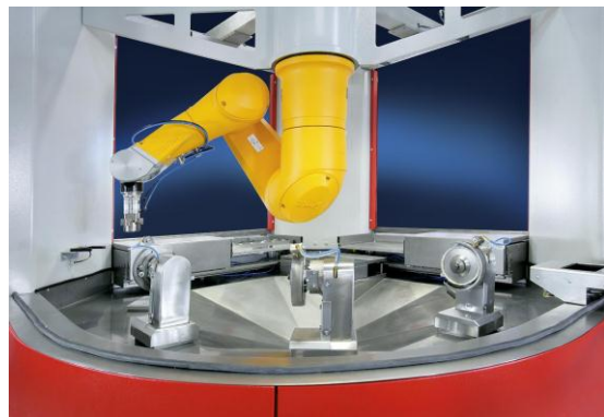
Bild Nr. 11-02 ZW_OE-Greifarm.jpg Der „Stäubli“ bewegt sich „verkehrt herum“. Zeltwanger hat ihn kopfüber an der oberen Verstrebung der Poliermaschine befestigt. Das bringt viele Vorteile.
