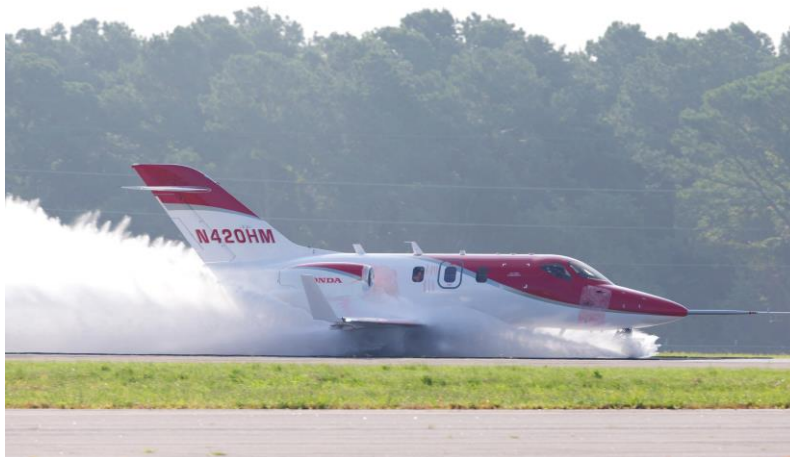
Wasseraufnahmetest des HondaJets bei der NASA (USA)
