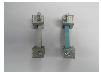
Eingespannte Stäbe nach Immersion in Olivenöl links: PC/ABS FR. rechts: PC/PBT FR (EXP 1950)
