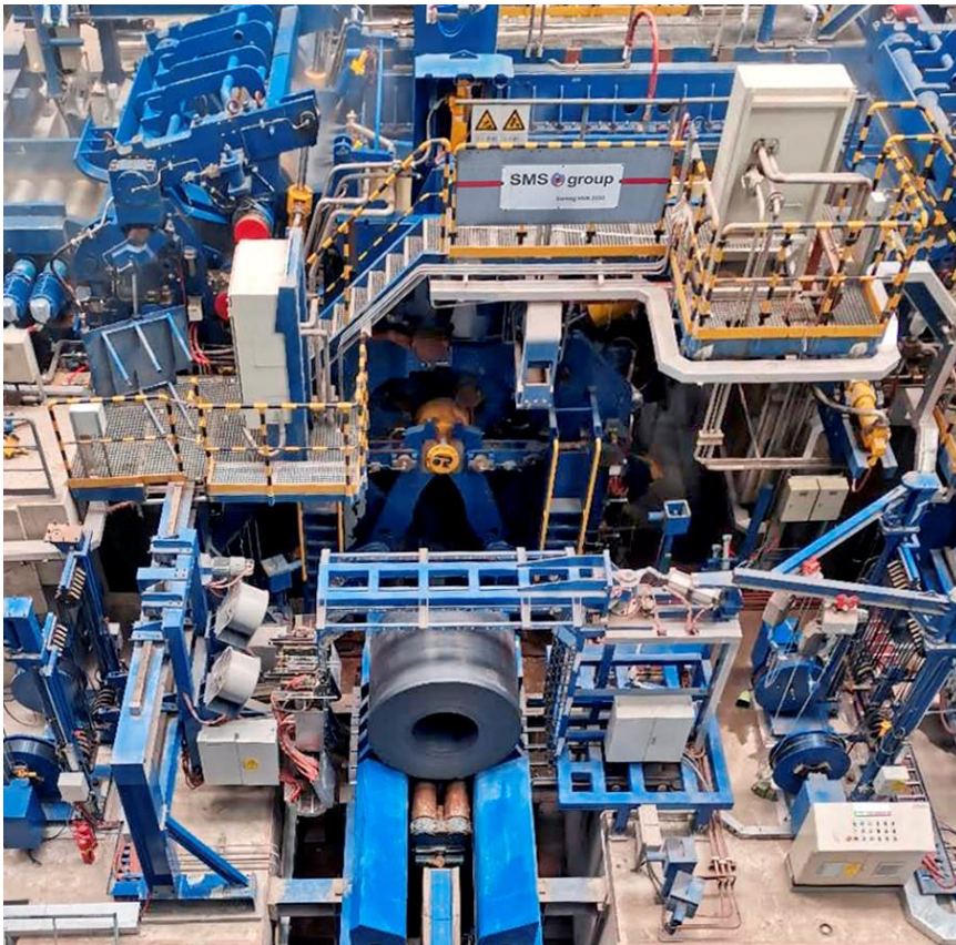
Einer von insgesamt drei Warmbandhaspeln der neuen Hochleistungs-Warmbandstraße von HBIS Laoting. Hier wurde am 8.August.2020 das erste Warmband aufgewickelt.
