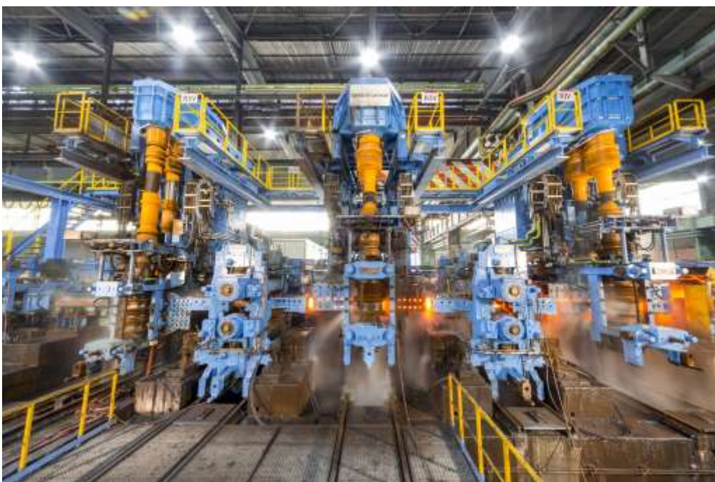
Das bestehende Trio-Vorwalzgerüst wurde durch eine sechsgerüstige kontinuierliche VorstraÙe mit Kompaktgerüsten ersetzt.
