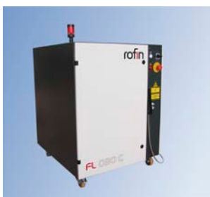
Bild 3: ROFIN FL 030 C mit einer Ausgangsleistung von 3 kW
