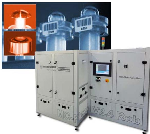
As calotas são utilizadas durante o processo de gravação e noutros passos da fase de produção para transportar lentes RGP, lentes de contacto e outro tipo de lentes especiais. A interacção de um robot mecânico de 5 eixos com uma calota de forma livre resulta numa combinação única que permite obter resultados de gravação individuais, muito finos e altamente preciosos, que se podem aplicar em qualquer posição da lente.
