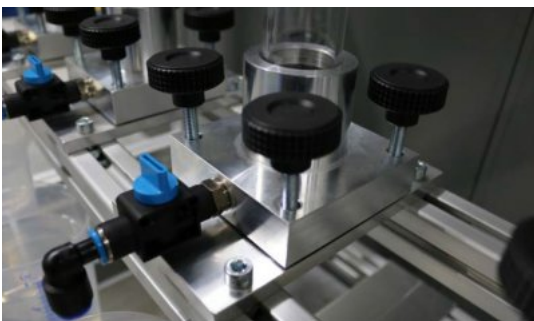
Bild2: Motivvorschlag: passendes Bild, z.B. einer der Prüfstände Bei Arnold Umformtechnik stehen für die Untersuchungen zur Dichtheit zwei Dichtheitsprüfstände zur Verfügung, die mit Prüfgas messen sowie weiterhin ein Dichtheitsprüfstand, der Wasser als Prüfmedium nutzt und einen IPX7-Nachweis ermöglicht.
