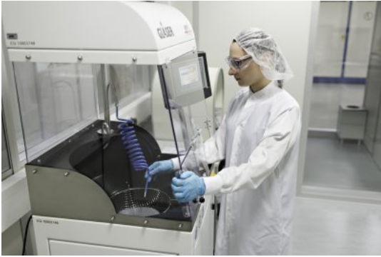
Bild3: Motivvorschlag: passendes Bild zum Extraktionskabinett In einem Extraktionskabinett werden bei Arnold die Schmutzpartikel vom Bauteil abgelöst und aufgefangen.
