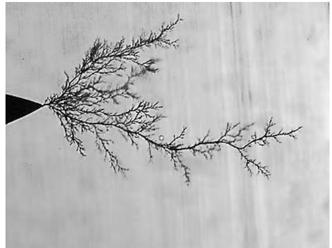
Ausbildung eines leitfähigen Pfades auf oder in Isolationsmaterialien
