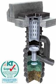
Im Gegensatz zum konventionellen Straßenablauf mit Schlammraum (SS) ist der aus Polyethylen gefertigte ACO Separationsstraßenablauf Combipoint PE (SSA), dank seiner 3 Separationsstufen, in der Lage, mit dem Straßenabfluss transportierte Schwimmstoffe und sedimentierbare Feststoffe mit den partikulär gebundenen Schadstoffen sicher zurückzuhalten und Mobilisierungen der bereits im Schlammraum abgelagerten Feststoffe auch bei Starkregenereignissen zu unterbinden.
