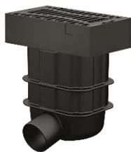
Der monolithische Straßenablauf aus Polyethylen kommt unter anderem bei der Verwendung von Heizwendelschweißmuffen im Bereich des Rohranschlusses zum Einsatz. Der werksseitige angeformte Stutzen ist aus PE. Das geringe Gewicht (je nach Größe zwischen 6,0 und 10,0 kg) macht den Einbau leicht und kostengünstig. Der Straßenablauf ist für die Klassen C 250 und D 400 ausgelegt. Wie alle Ausführungen der Straßenabläufe ACO Combipoint ist auch die Ausführung
