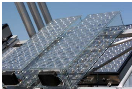
Foto: Das neuentwickelte FLATCON ® -Konzentratormodul mit einem weiteren optischen Konzentrator direkt über der Solarzelle, montiert auf dem Außenmessplatz des Fraunhofer ISE. Quelle: Fraunhofer ISE.
