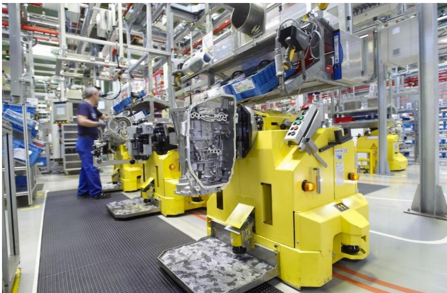
Bildunterschrift: Montage des 8-Gang-Automatgetriebes von ZF für Pkw
