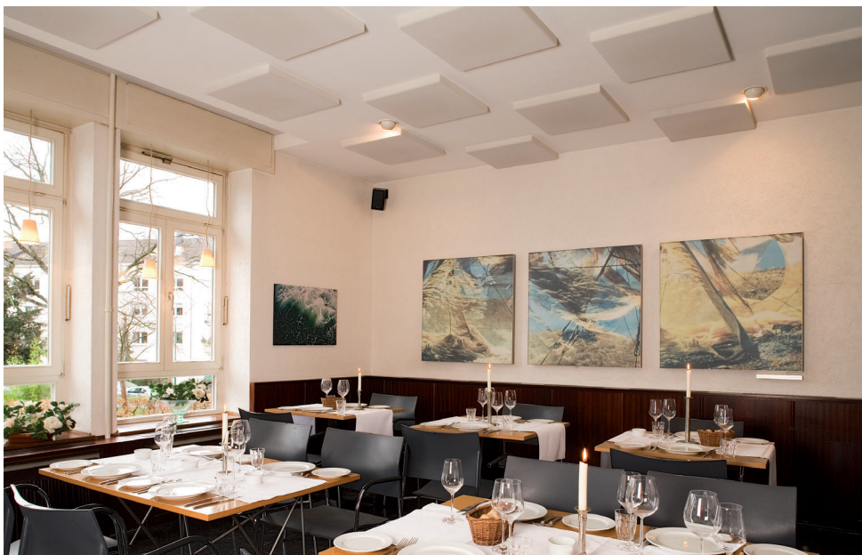
Alle Register effektiven Schallschutzes wurden von Caparol im Restaurant Müller & Müller gezogen. Sogar die Fotografien an der Wand helfen – sie sind auf Melapor-Akustikplatten aufgebracht.
