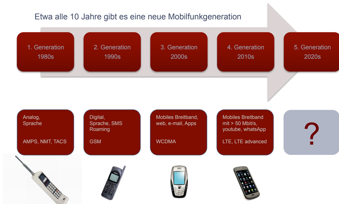
Abbildung 1: Mobilfunk Generationen (SBR basierend auf Qualcomm)
