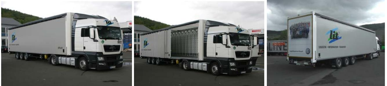
Der ORTEN Mega SafeServer wurde eigens ausgelegt zur Aufnahme eines automatisch in den Auflieger einzubringenden 13,6 m langen Ladegutträgers, entwickelt von der Engineering Gesellschaft CLSI Leer. Die derzeit wohl rationellste und schnellste Lösung automatischer Belade- und Entladelogistik. In nur ca. 15 Minuten kann ein kompletter Sattelzug vollautomatisch be- und entladen werden und ermöglicht somit im 4 Rampenbetrieb den rationellen Umschlag von täglich mehr als 80 Sattelzügen!
