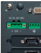
Power Ignition-Funktion, zeitgesteuertes Herunterfahren, ideal für KFZ-Anwendungen
