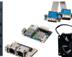
Universal Bracket für Mini-PCIe Module wie z.B. serielle, USB, LAN, oder optional interner Lüfter für Slotkartenbelüftung (nur für 2-Slots Modelle)
