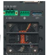
Universal Bracket für Mini-PCIe Module wie z.B. serielle, USB, LAN, oder optional interner Lüfter für Slotkartenbelüftung (nur für 2-Slots Modelle)
