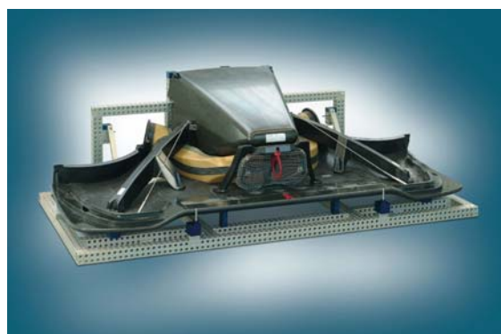
Links und rechts: Frontnase mit Flügel wurden auf der zuvor justierten Alufix-Vorrichtung fixiert
