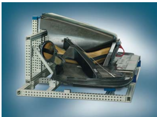
Links und rechts: Frontnase mit Flügel wurden auf der zuvor justierten Alufix-Vorrichtung fixiert
