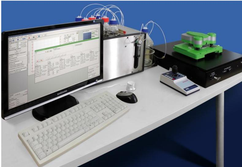
*Das ForceRobot® 300 System zur Einzelmolekül-Kraftspektroskopie*
