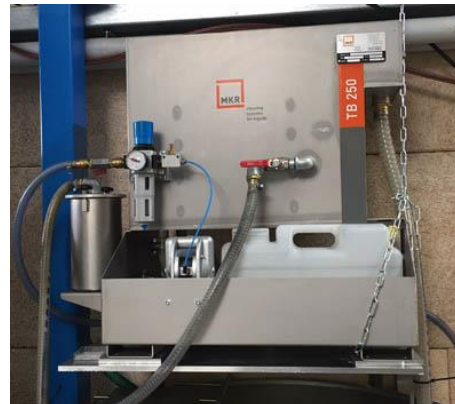
Bild Nr. 10-04 MK_KL-TB250.jpg. Die drei Fremddölabscheider TB 250 von MKR Metzger arbeiten energieeffizient nach dem Koaleszenzprinzip.
