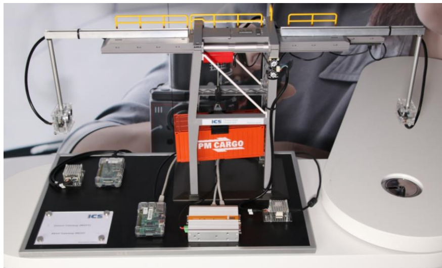
Messedemonstrator für sichere Maschinensteuerung – hier mit der Sicherheitskomponente IRMA
