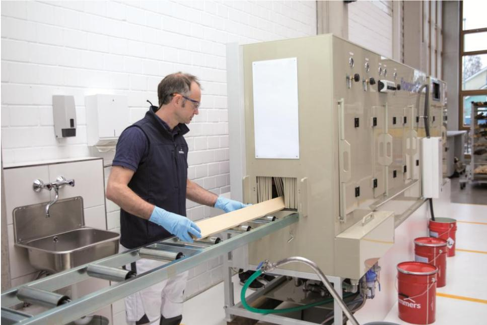
Induline SW-935 kann als farblose Imprägnierung mittels Floccoroll G von der Firma Range & Heine auf die Fensterkante aufgebracht werden.
