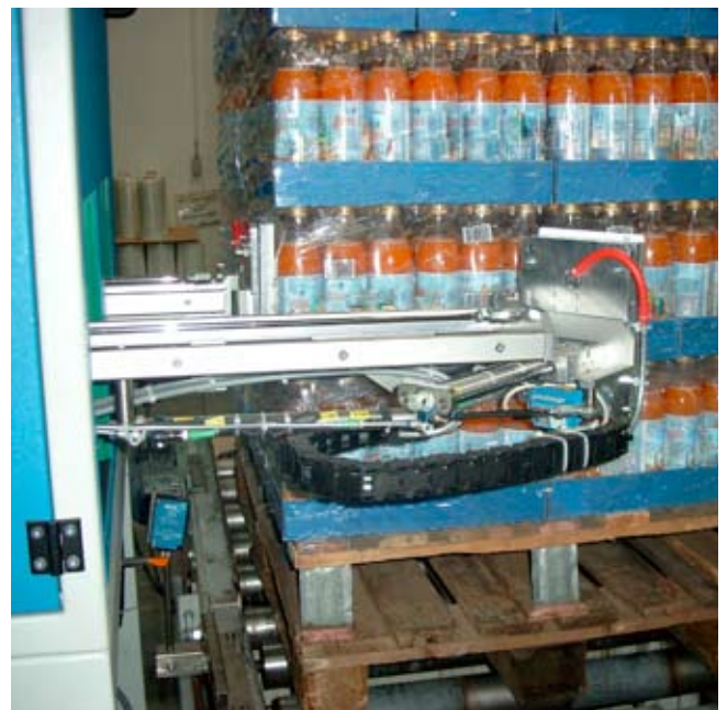
Applizierdrucker müssen üblicherweise vom Servicedienst programmiert werden. Mit LOMAS können Layouts schnell gewechselt und kundenspezifisch Daten (z.B. MHD, Herstellungsdatum) berechnet werden.
