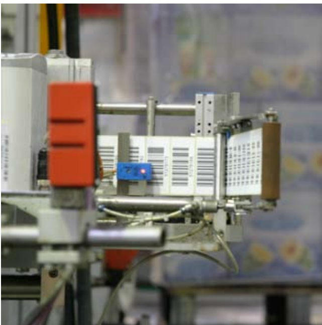
Von der Rolle aufgespendete Transportetiketten ordnet LOMAS mittels Scanner direkt der produzierten Palette zu. Je nach Wunsch Ihrer Endkunden können individuelle Paletten zusätzlich mit EAN128-Etiketten nach dem GS1-Standard versehen werden.
