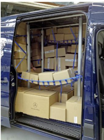
Bild: „TransSAFE Rack“ beladen mit Paketen
