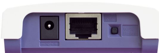
Gigabit Ethernet Verbindung und WPS Knopf
