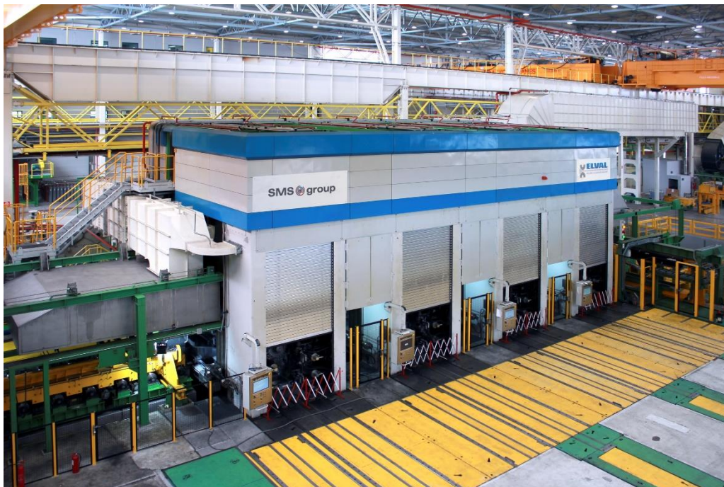
Die neue viergerüstige Fertigstraße von ElvalHalcor S.A.
