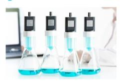
Setzen sie die Steuereinheit auf die Kartusche und bringen beides auf dem Schüttelkolben an. LIS führt nun automatisch Ihr Feedingprofil durch.
