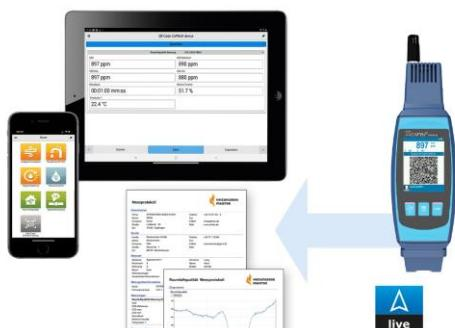
Die Übertragung der Messdaten erfolgt mittels QR-Code, anschließend stehen umfassende Möglichkeiten zur Analyse sowie zur Dokumentation der Messergebnisse zur Verfügung.
