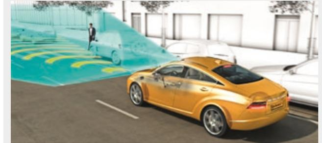
Der vorausschauende Notbremsassistent reagiert mit einer automatischen Bremsfunktion, sobald sich das eigene Fahrzeug einem vorausfahrenden gefährlich nähert oder ein Fußgänger die Fahrbahn betritt. Dadurch kann der Anhalteweg deutlich verkürzt werden. Das EBA kommt auch bei Lkw zum Einsatz, um schwere Auffahrunfälle zu verhindern.
