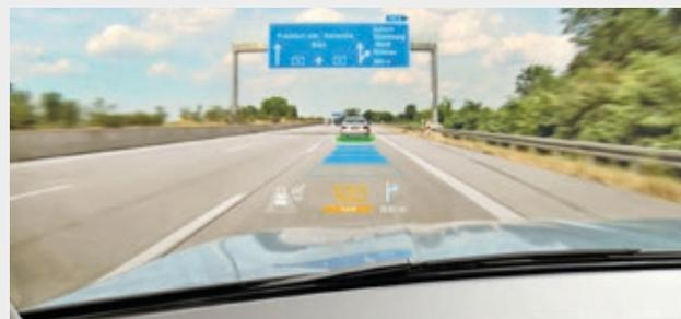
Die Verkehrszeichenerkennung (Traffic Sign Recognition) erinnert den Fahrer über eine Anzeige an die gegenwärtig erlaubte Höchstgeschwindigkeit. Ermöglicht wird dies durch die Mehrfachnutzung der Kamera, die auch für das Lane Departure Warning System eingesetzt wird. In Kombination mit hochleistungsfähiger Software kann sie so auch die Schilder mit spezifischen Tempolimits erkennen.
