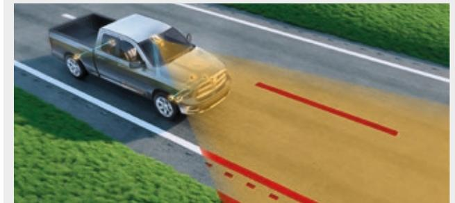
Die Road Departure Protection ist ein System, mit dem ein Abkommen von der Fahrbahn verhindert wird. Es ist eine Weiterentwicklung der Lane Departure und Lane Keeping Systeme, die mit Warnhinweisen arbeiten, wenn das Fahrzeug droht von der Fahrbahn abzukommen. Das RDP hingegen greift aktiv ein und steuert das Fahrzeug wieder zurück in die Spur.
