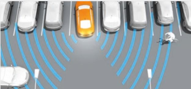
Die Ausparkhilfe Rear Cross Traffic Alert (RCTA), nutzt dieselbe Radarinfrastuktur wie bei der Erkennung von Fahrzeugen im toten Winkel (Blind Spot Detection, BSD) und kann Unfälle beim Ausparken in unübersichtlichen Situationen vermeiden, die oftmals zu schweren Kollisionen führen und auch Personenschaden zur Folge haben können.
