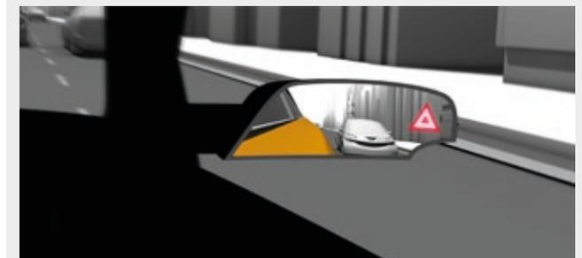
Das Blind Spot Detection (BSD)-System zur Überwachung des toten Winkels kann dazu beitragen, den Autofahrer deutlich zu entlasten und unfallträchtige Situationen zu vermeiden. Sensoren überwachen den Verkehrsraum hinter und neben dem eigenen Fahrzeug und schlagen Alarm, wenn der Fahrer zum Beispiel trotz fehlender Lücke ausscheren will.
