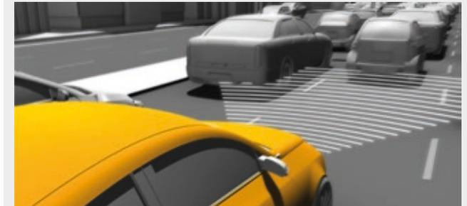
ACC ist mehr als nur ein Tempomat: Das System folgt dem vorausfahrenden Verkehrsfluss, auch wenn es nur noch Stop-and-go voran geht. Schon auf den täglichen Strecken, zum Beispiel zur Arbeit, ermöglicht ACC eine neue Mobilität, die einen nicht nur sicherer ankommen lässt, sondern die Fahrt trotz der Hektik auf den Straßen wieder entspannter werden lässt.
