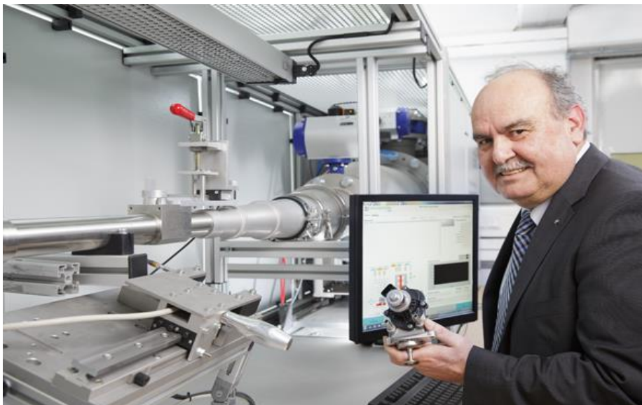
Vor der Serienreife müssen Abgasrückführventile umfangreiche Prüf- und Härtetests durchlaufen: Osman Sari, Chefentwickler bei Pierburg für das neue Kompakt-AGR, an einem Strömungsprüfstand.
