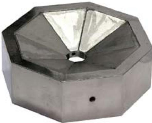
Am ITCF entwickelte Hochenergie-Magnetfeldspule zur Faserstrukturierung.
