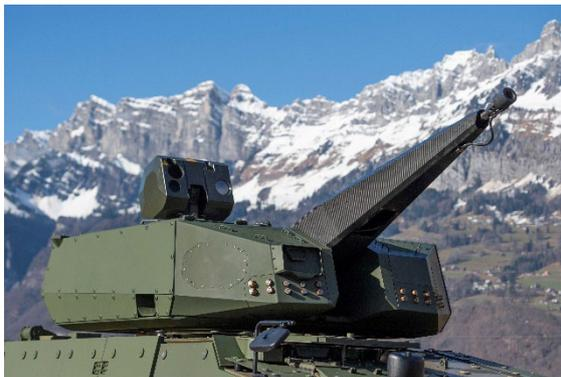
Ein Teil der österreichischen Pandur-Flotte – 36 Fahrzeuge – wird mit dem Skyranger-Turm ausgerüstet, um Aufgaben der mobilen Fliegerabwehr übernehmen zu können. Skyranger vereinigt modernste Sensoren, eine leistungsstarke 30mm Rohrbewaffnung sowie Lenkflugkörper, in diesem Fall Mistral.
