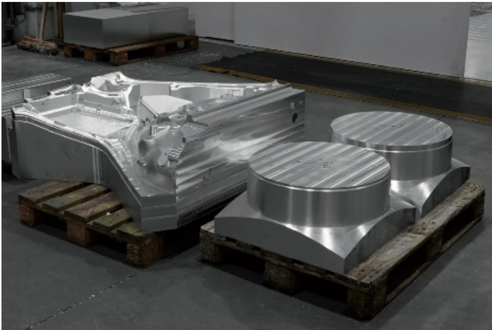
Bild Nr. 109-02 AM_MT-Teile Karosserie-Seitenteil und Alufelgen werden aus dem Vollen zerspant.
