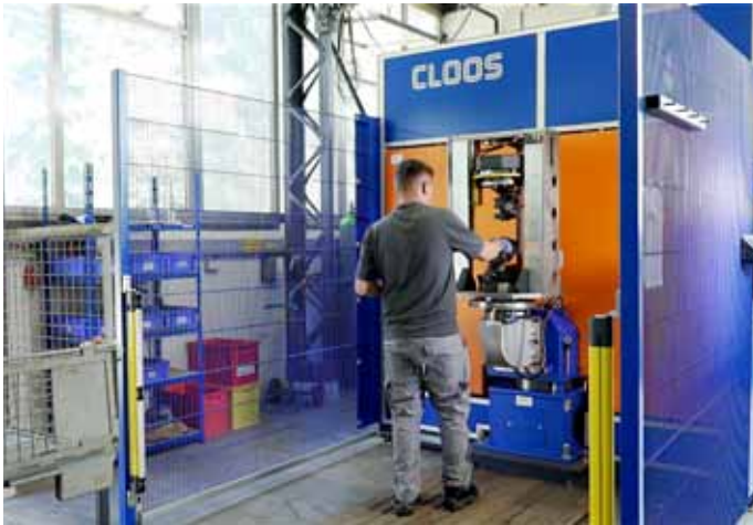
Bild 3: Der Zweistationen-Aufbau ermöglicht das gleichzeitige Schweißen und Bestücken der Kompaktzelle
