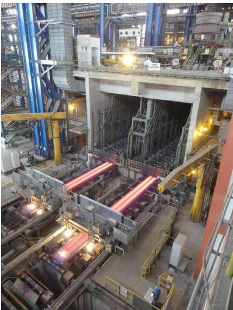
Die 2016 von SMS group gelieferte Zweistrang-Brammengießanlage bei Tata Steel in Kalinganagar.
