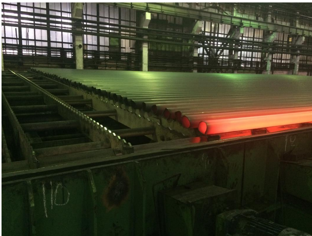
Nahtlose Stahlrohre auf dem Kühlbett der PQF ® -Anlage bei Tagmet.
